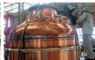
蒸留釜製造の様子
