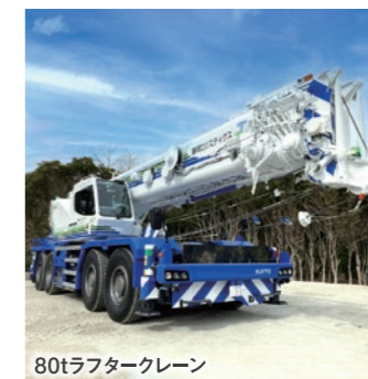
80tラフタークレーン
